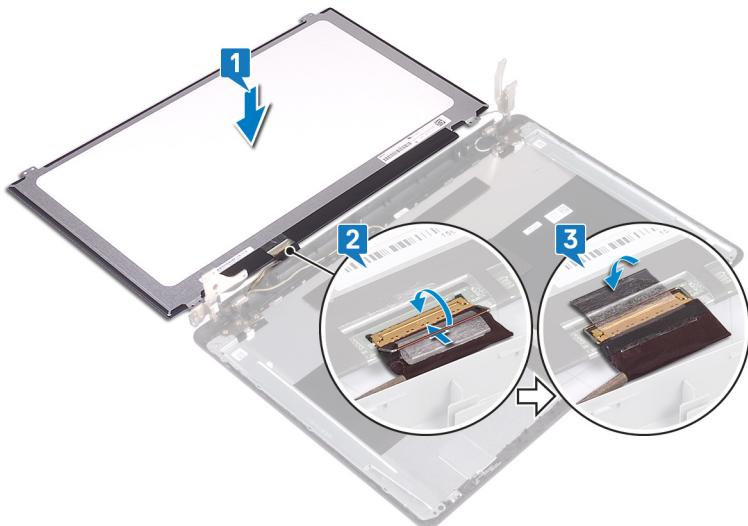
4. Postavite ploču ekrana na sklop zadnjeg poklopca ekrana i antene.
