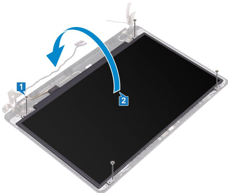
3. Odlepite traku koja učvršćuje kabl ekrana za zadnji deo ploče ekrana.
