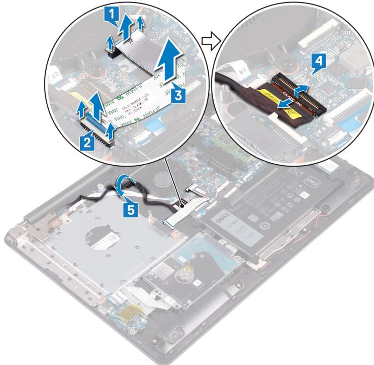
6. Isključite kabl ventilatora iz matične ploče.
